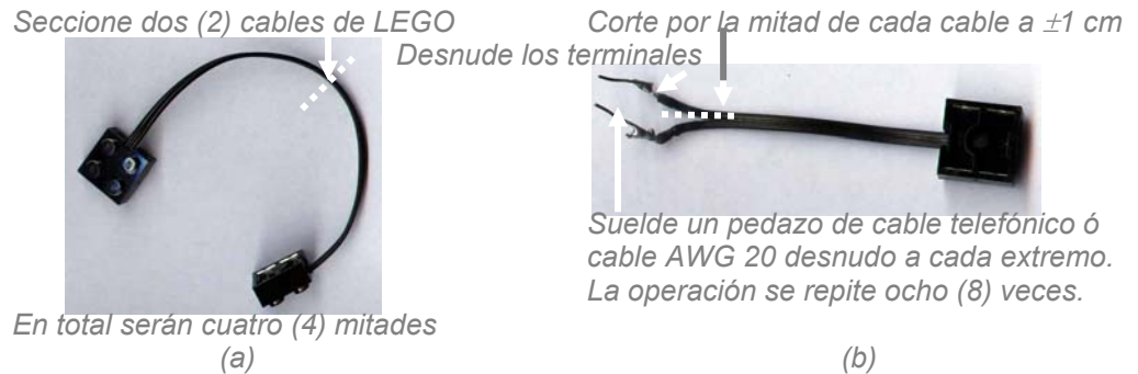
Figura 176. Conector LEGO. (a) Cable del “Kit Mindstorms”. Corte por la mitad para dos (2) cables. (b) Cable seccionado. Seccione, desnude y suelde un alambre a sus extremos para poder insertarlos en el “protoboard”.
