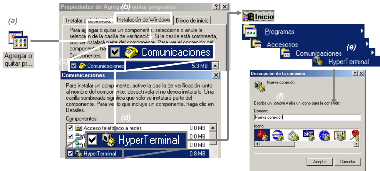
Figura 192. Instalación de “HYPERTERMINAL”. (a) Agregar o Quitar Programas. Inicie en Panel de Control el icono de agregar programas. (b) Instalación de Windows. Elija la pestaña de instalación. (c) Comunicaciones. En el menú, seleccione la opción comunicaciones. (d) “HyperTerminal”. Entre todas las selecciones, elija “hyperterminal” y presione aceptar, espere a que “windows” instale la aplicación. (e) Búsqueda de la aplicación. Navegue desde la barra de inicio y cargue “hyperterminal”. (f) Conexión. Utilice un nombre cualquiera como “mi conexión” para iniciar una conexión.
