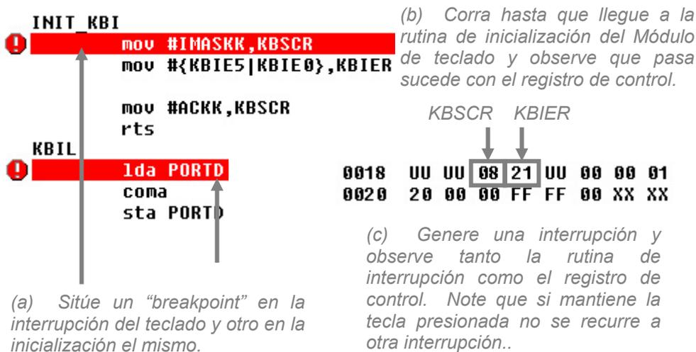
Figura 165. Simulación del Programa Principal. (a) "Breakpoint". Sitúe un "breakpoint" para visualizar la configuración de pines de teclado. (b) Rutina de Inicialización de Teclado. Note que pasos hay que seguir para inicializar un módulo de teclado. (c) Interrupción. Genere una interrupción presionando una tecla y observe que pasa si la tecla queda presionada.
