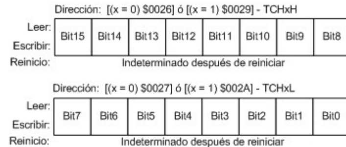
Figura 148. Registros del Canal del TIM – IC. Al configurar el canal como "input capture" y al darse el flanco de captura, el TIM almacena en el registro del canal correspondiente el valor de la cuenta. (TCHx[H:L] ← TCNT[H:L]).
