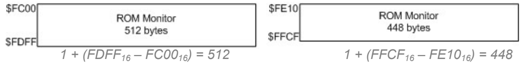
Figura 82. Diagrama de Bloques de la Memoria ROM. La memoria ROM es una memoria no volátil, de solo lectura y no modificable por el CPU. En especial, esta ROM trae rutinas incorporadas que son las que permiten conectarse al programa WinIDE o rutinas de programación de la memoria FLASH.
