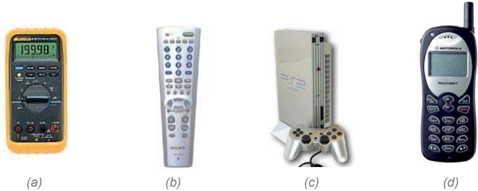
Figura 74. Ejemplos Comunes de Sistemas Embebidos. Los sistemas embebidos son la aplicación final de un sistema con microcontrolador. (a) Equipo de medición. (b) Equipo casero. (c) Consola de videojuego. (d) Equipo de uso personal.
