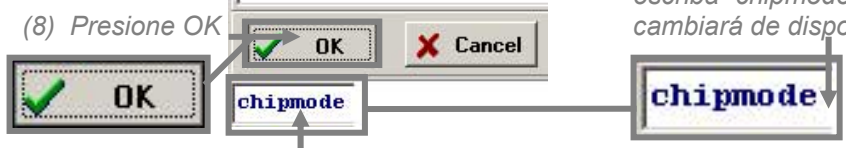
Figura 69. Entrada al simulador. (a) Ventana de contactar objetivo y seguridad. Presione "Contact target with this settings..." y espere a entrar a modo monitor, si vuelve a aparecer la ventana, apague y encienda la tarjeta nuevamente; ejecute el paso tres (3). (b) Cambio de dispositivo. En la caja de texto de entrada de línea de comandos, escriba "chipmode", presione "enter" y finalmente seleccione el tipo de microcontrolador de trabajo.
