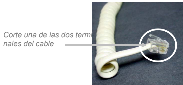
Figura 61. Cable Telefónico. Corte una de las dos terminales para fabricar el cable serial.
