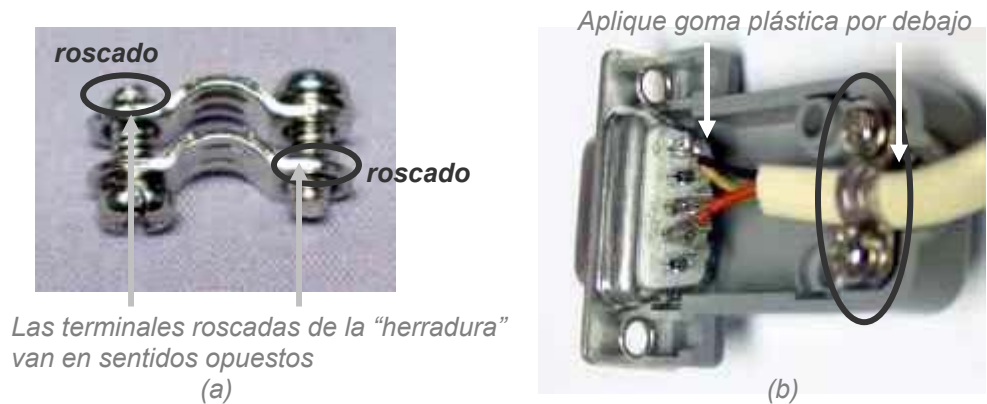
Figura 63. Conector DB9 – Soldadura. (a) Grapa o mordaza. Amordace el cable construyendo la grapa con sus terminales roscadas opuestas. (b) Interior del cable al DB9. Suelde y aplique goma plástica debajo del DB9 y debajo de la mordaza.
