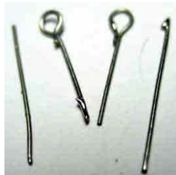
Figura 60. Puntos de Prueba. Enrolle sobre la punta del multímetro y apriete con una pinza de punta larga.
