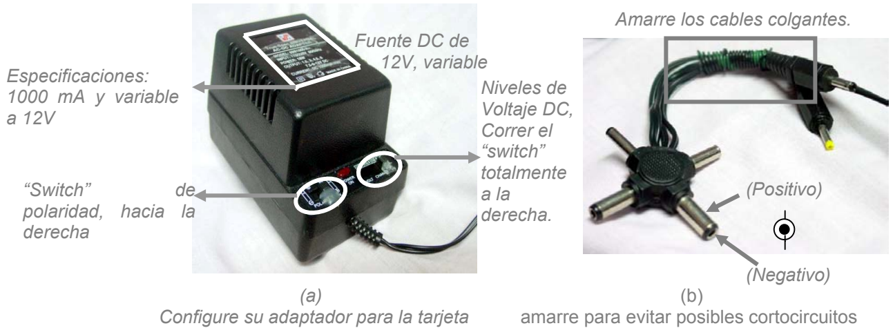
Figura 64. Adaptador de “Power”. (a) Verifique que su adaptador es de especificaciones correctas para su tarjeta. Todos los interruptores delanteros trásélalos a la derecha. (b) Amarre las terminales. Evite cortos amarrando las terminales colgantes.
