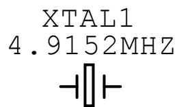
Figura 30. Cristal Resonador de Cuarzo. Proporciona pulsos de sincronía para el microcontrolador.
